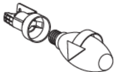
18. ábra Halogén izzó kicserélése
