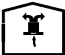
5. ábra Szénszűrős belső keringetési üzemmód
